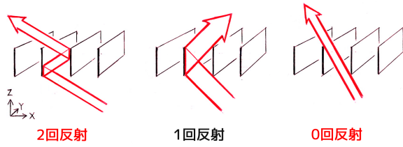
図 3: SMA における光線の反射回数と向き。
