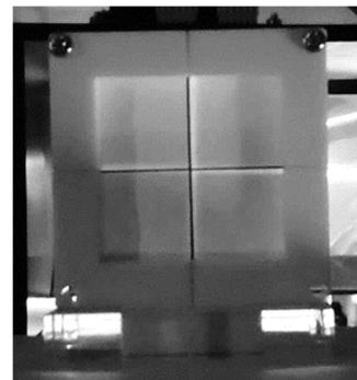
図 6: 空中像が治具内部の和紙で拡散する様子
