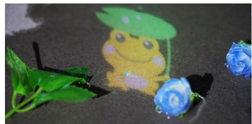
図12 噴水面上に表示した空中像
