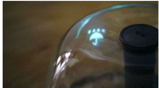
図12 噴水面上に表示した空中像
