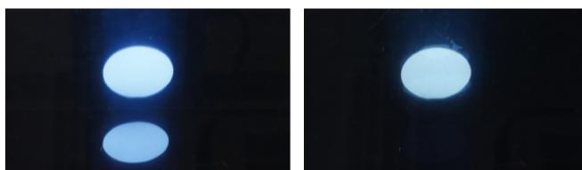
図5 PortOn による不要光の除去(左: 偏光操作がなしなため、不要な地中の像が見える 右: 空中像だけが見える)
