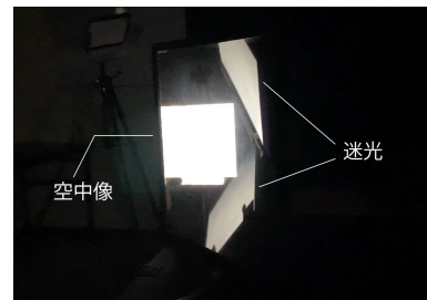
図 1: MMAP を用いた光学系で迷光が生じている様子
